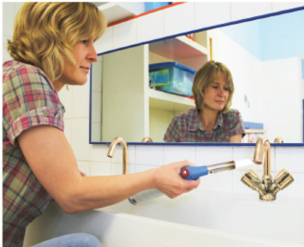
Die Trinkwasserkontrollen in Deutschland zählen zu den schärfsten weltweit. Hygieneinspektorin Antje Ott vom Gesundheitsamt analysiert in diesem Sinne das Wasser einer Kita im Landkreis Oder-Spree. Bevor sie die Probe für den mikrobiologischen Test entnimmt, flämmt sie den Hahn ab, damit er keimfrei wird.
