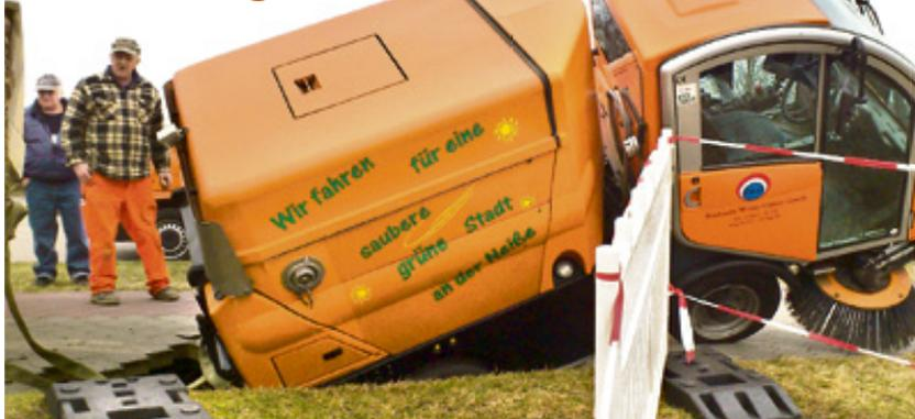
Wie wichtig planmäßige Erneuerungsinvestitionen sind, zeigt in kurioser Weise dieses Bild. Die Kehrmaschine brach am 14. März 2012 in eine Unterspülung ein. Die Ursache dafür war ein mehrere Meter entfernt liegender Wasserrohrbruch.
