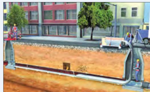
**Abb. 2: So funktioniert ein Linereinzug in den Kanal.**
